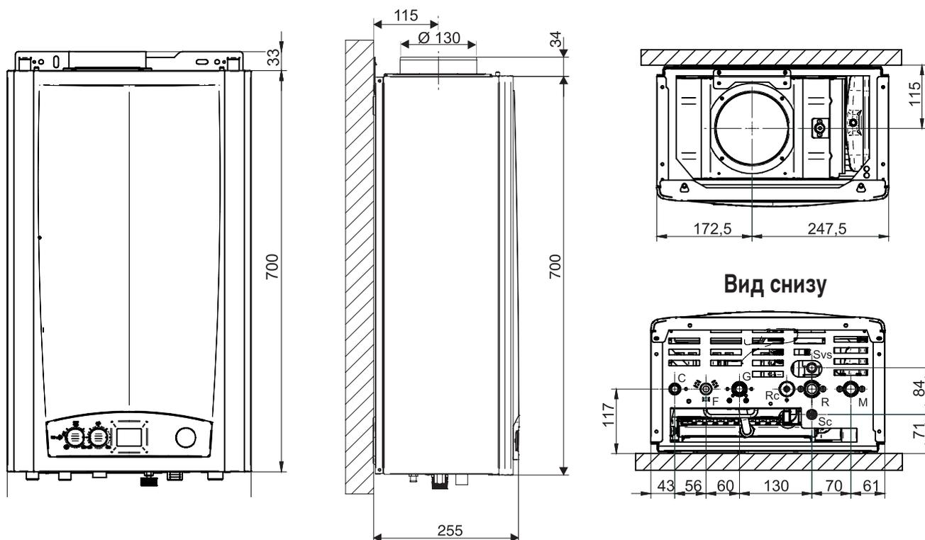
VorTech One CS16 - CS18 - CS18R - One CS24 - CS24R - Duo CS24
