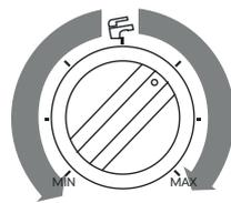
Изменить значение ранее выбранного параметра при помощи регулятора температуры ГВС "С". Новое значение будет мигать на дисплее.
