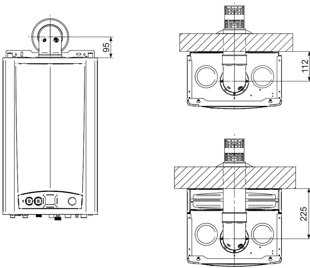
РАЗМЕРЫ ПОДКЛЮЧЕНИЙ ДЛЯ РАЗДЕЛЬНЫХ ДЫМОХОДОВ
