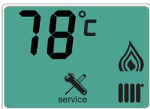
При нажатии кнопки (D) и повороте регулятора (B) в максимальное положение, котел будет работать на максимальной мощности (символы = горят постоянно)
