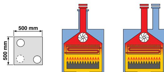
**C42** Конструкция котла разработана для использования с коллективными системами дымоходов, имеющими 2 трубы: одну для прямого забора воздуха, вторую для отвода продуктов сгорания посредством коаксиальных или раздельных систем дымоходов.
