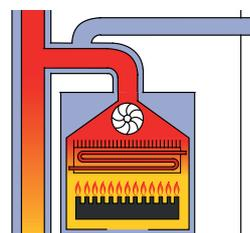
**B22** Котел, предназначенный для подключения к наружному дымоходу, забор воздуха происходит непосредственно из помещения, в котором установлен котел
