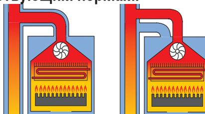
**C52** Котел с отдельными трубами забора воздуха и отвода продуктов сгорания.
