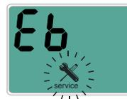
2) При наличии неисправности, которая приводит к остановке котла, код ошибки мигает на дисплее.
