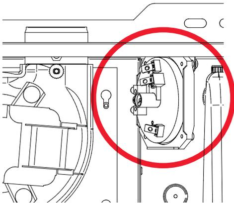
В случае срабатывания устройства котел блокируется и на дисплее отображается неисправность (символ
