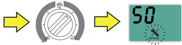
Изменить значение параметра при помощи регулировочной рукоятки ГОРЯЧАЯ ВОДА.
