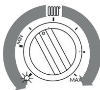
Повернуть регулятор температуры ОТОПЛЕНИЯ "В" для выбора изменяемого параметра: Po - oC - nr - HP; параметры отображаются на дисплее "E".
