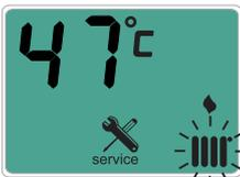
При повороте регулятора (B) в минимальное положение, котел будет работать на минимальной мощности. (символы будут гореть постоянно, будет мигать).
