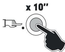
Для входа в параметры нажать и удерживать нажатой в течение 10 сек. кнопку разблокировки котла (отпустить, когда на дисплее появится мигающий символ)
