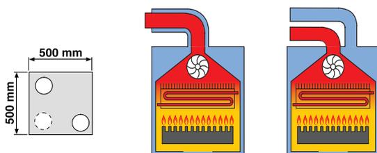
**C32** конструкция котла разработана для использования с вертикальными системами дымоходов и прямым забором воздуха (коаксиальные или раздвоенные системы дымоходов).
