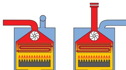
**C62** Котел, предназначенный для подключения к системам подводки воздуха и отвода продуктов сгорания, поставляемых отдельно от котла.
