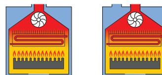
**C82** Котел, предназначенный для подключения к коллективной системе забора воздуха и индивидуальным или коллективным дымоходом для отвода продуктов сгорания.
